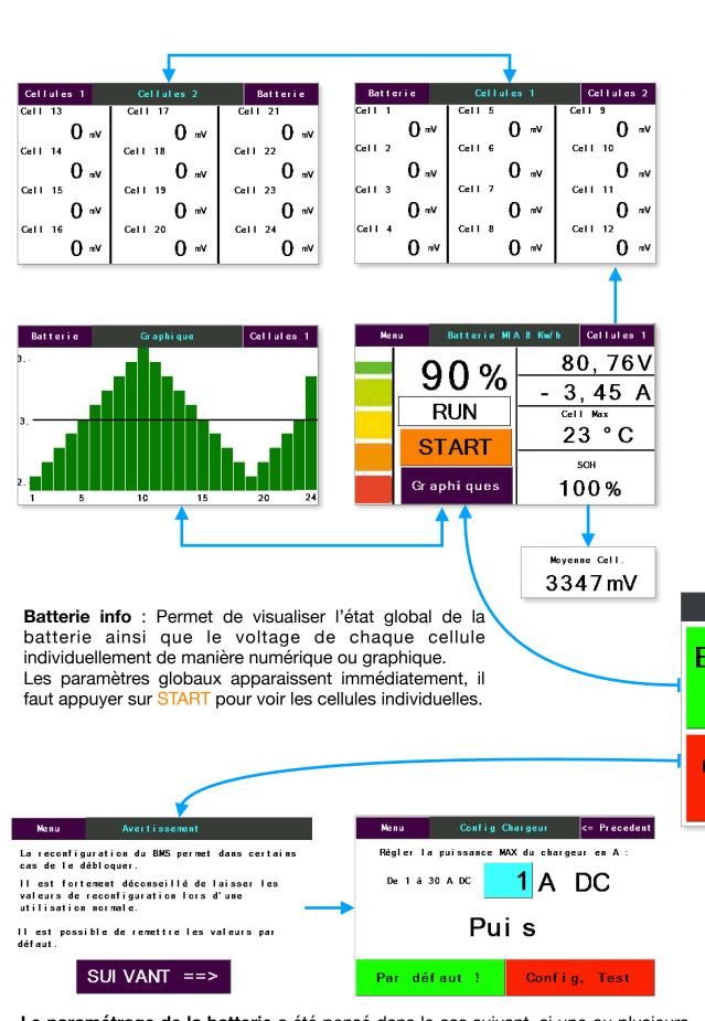
Le paramétrage de la batterie a été pensé dans le cas suivant, si une ou plusieurs cellules sont descendues en dessous de 2,8 V. Commencer par régler la puissance maximum à laquelle le chargeur chargera la batterie.
